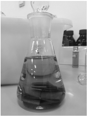
图 2 油纸老化试样
